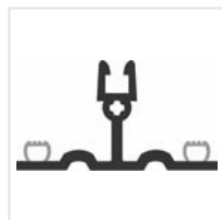
Therm - PVC-draagprofiel met coëx steunrubbers
